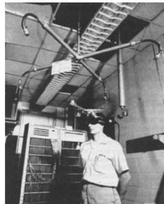
Figura 10 e 11 - O *The Ultimate Display*, um HMD conectado ao computador
